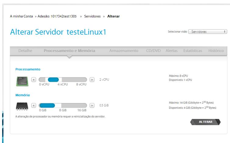
Ecrã de processamento e memória na alteração de servidor 4-21
